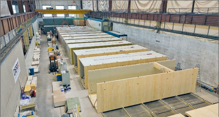
Die Raumzellen aus Brettsperrholz wurden in Deutschland seriell weitestgehend vorgefertigt und just in time auf die Baustelle in den Niederlanden transportiert.
