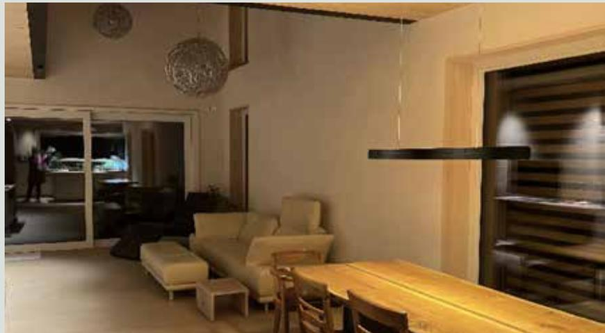
Außer Holz wurden ca. 20 Tonnen Lehmbaustoffe eingebaut, die für ein ausgeglichenes Raumklima sorgen. Durch einen Lehm-Kalkboden mit Fußbodenheizung/-kühlung, eine dekorative Wand aus Stampflehmsteinen sowie Wand- und Deckenheizungen aus Lehmplatten wird der Holzbau um massereiche Baustoffe ergänzt.
