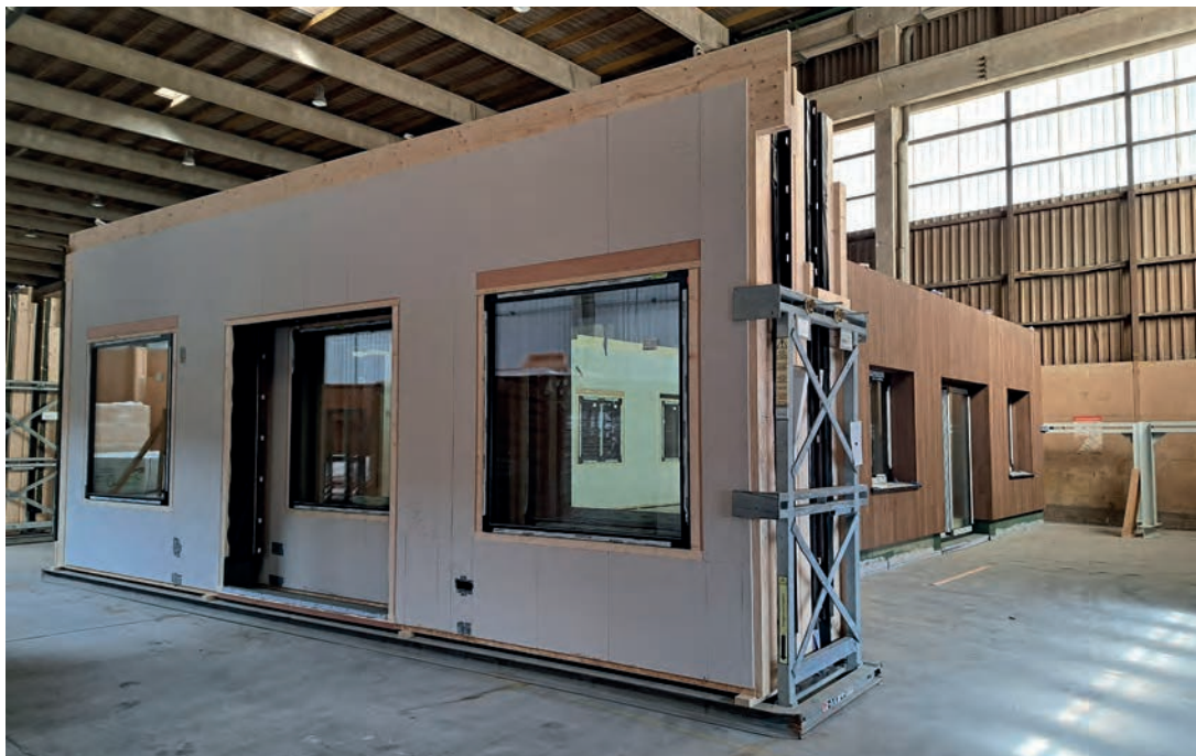
De gevelelementen zijn in hoge mate geprefabriceerd, inclusief bamboe bekleding, beglaasde kozijnen en ingebouwde zonwering.
