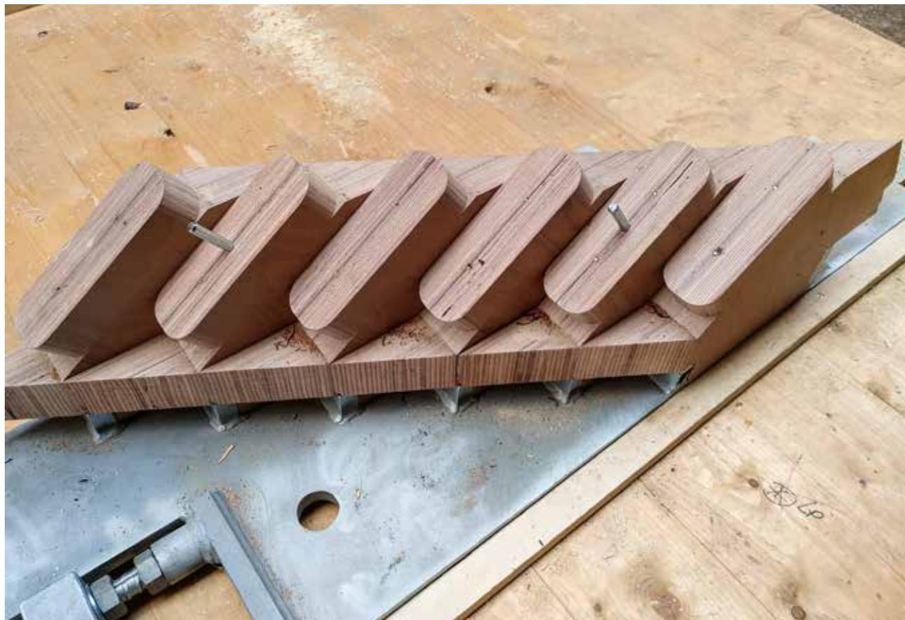
Ein mittels CNC-Technologie gefrästes BSH-Element auf einer Stahlplatte bildet die Steckverbindung zu den Fassadenelementen.
