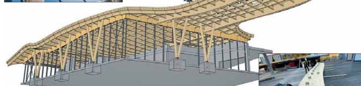
Axonometrie der Dachkonstruktion. Das äußere Sekundärtragwerk basiert auf fünf V-förmigen BSH-Rundstützenpaaren, die das Gebäude an zwei Seiten umsäumen (Foto oben). Grafik: Planungsbüro Winter
