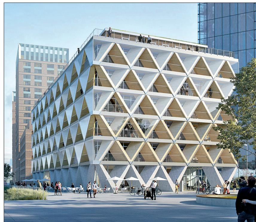
Über dem Erdgeschoss werden „The Cradle“ fünf Vollgeschosse und ein Teilgeschoss in demontierbarer Holzbauweise aufgesetzt.
