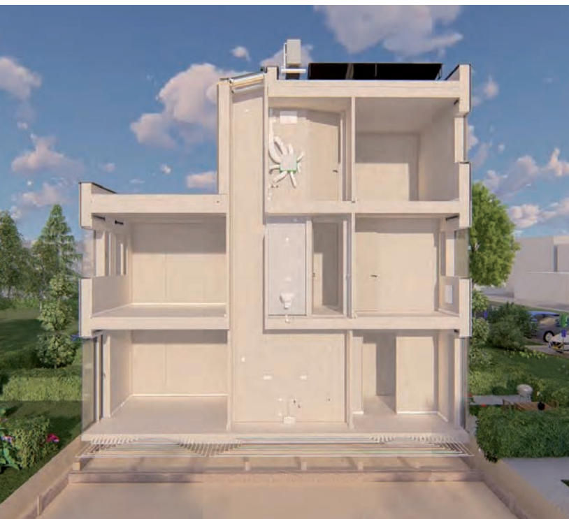
De zonneshoorsteen met bovenin de Velux-ramen die met een app bediend kunnen worden. De smalle strook glas halverwege zorgt voor natuurlijk licht in de badkamer.
