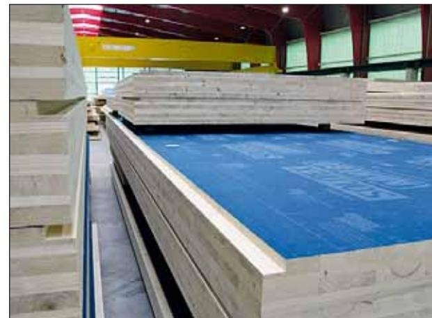
Zur Auslieferung bereit: Eine zusätzliche Folie (blau) schützt diese BSP-Deckenelemente während der Montage für den Fall, dass sich Feuchtigkeit nicht ganz vermeiden lässt.
