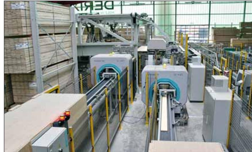
Jedes Brett wird mittels Röntgen-, Kamera- und Laser-Sensorik umfangreich auf seine Eigenschaften untersucht, wobei Oberflächenqualität, Festigkeit, Feuchtigkeit, Jahrringverlauf und Krümmungsverhalten im Vordergrund stehen.
