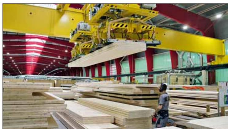
Einem Goliath unter den Hallenkränen gleich kommt der neue Portalkran, der mit einer Spannweite von 42,5 m nahezu die gesamte Halle auf einer Länge von 220 m durchfahren kann.
