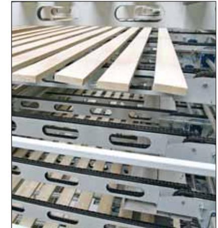
Die keilgezinkten und auf Länge gebrachten Einzellamellen härten in einem sechsstöckigen Etagenlager aus, bevor sie chargenweise (Brettlage für Brettlage) flächenverleimt werden.
