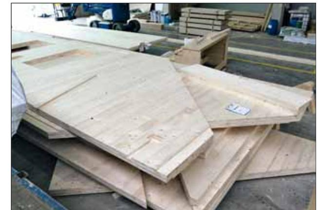
Die Größe der Produktionschargen richtet sich nach den zu beladenden LKW, während die Reihenfolge innerhalb einer Produktionscharge der Verladereihenfolge auf dem LKW respektive der Montagereihenfolge auf der Baustelle folgt.
