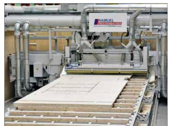
Drei baugleiche und parallel angeordnete Portalanlagen übernehmen den Abbund der Bauteile, wobei ein fünfschiger Werkzeugkopf zum Einsatz kommt.
