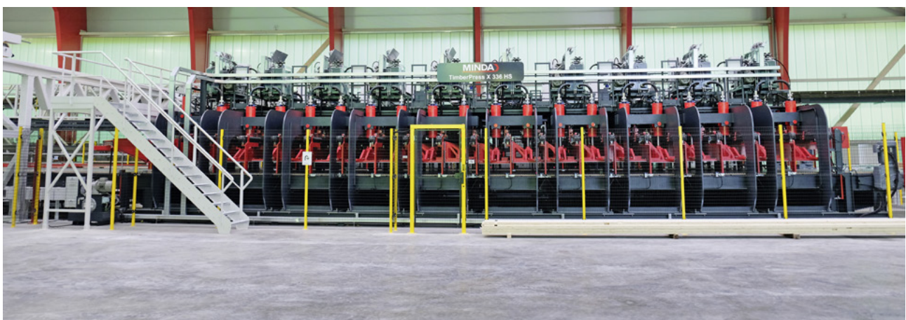
Bei Derix in Westerkappeln installierte Minda zwei HS-Hochgeschwindigkeitspressen für eine Anlagenkapazität von rund 100.000 m 3 /J
