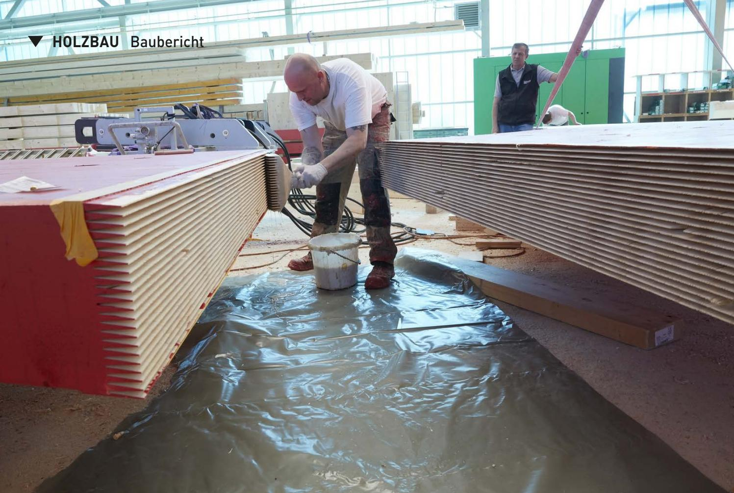
Produziert wurden die Brettschichtholzrahmen in einem Derix-Werk am Standort Westerkappeln. Die Rahmenelemente haben keilförmige Zinken, die verklebt ...
