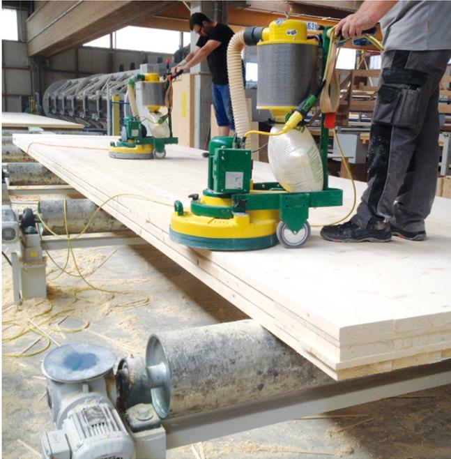
Holzbauteile wie etwa Decken wurden vor dem Einbau vorkonstruiert.
