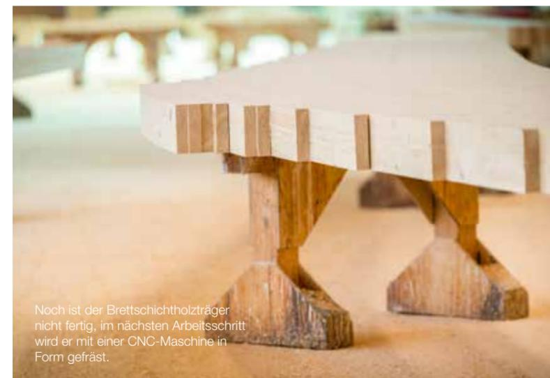
Noch ist der Brett-schichtholzträger nicht fertig, im nächsten Arbeitsschritt wird er mit einer CNC-Maschine in Form gefräst.
