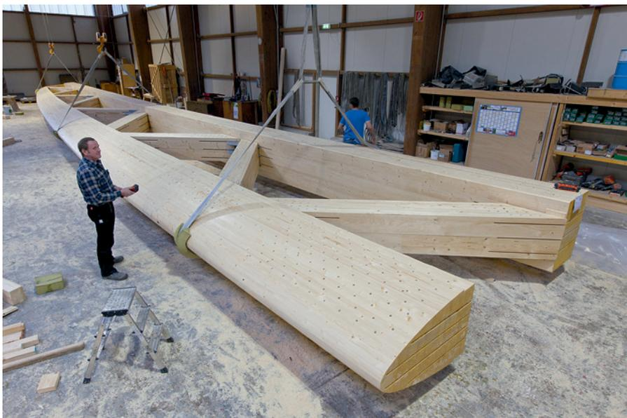
Unter der Bekleidung der flügelähnlich geformten BS-Holzträger verbergen sich Fachwerkbinder. Die Knoten sind mit Schlitzblechen und Stabdübeln verbunden.
