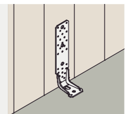
Uitgespaarde stootverbinding met zelfborende schroeven onder een hoek
