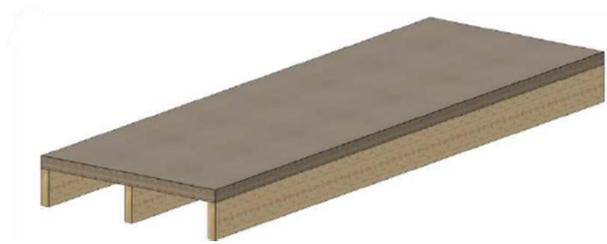
Abbildung 1-2: Rippendecke, Randrippen schließen bündig mit der Beplankung ab
