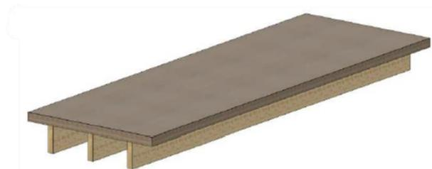
Abbildung 1-3: Rippendecke mit drei Rippen und seitlichem Überstand der Beplankung
